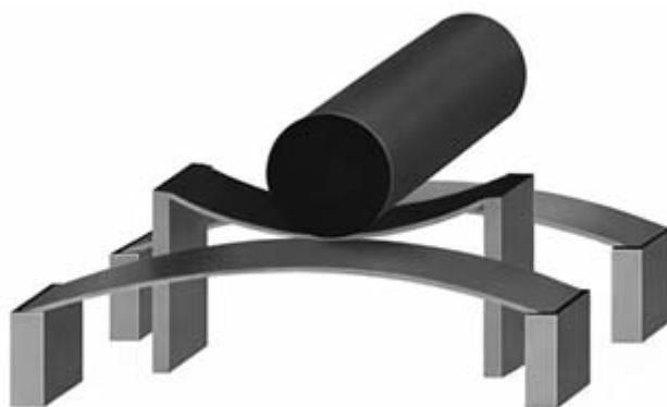
Рис. 4 Внешний вид конструкции опор надземного трубопровода
