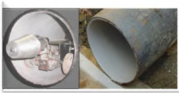
Նկ. 2. Պաշտպանական պոլիմերային ծածկույթով խողովակ ա) ծածկույթի փոշեցրման սարքավորում, բ) պոլիմերային ծածկույթով խողովակ
