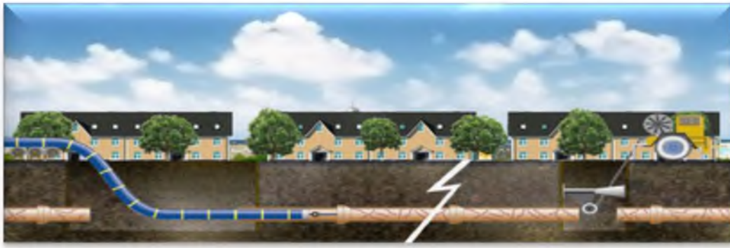
Նկ. 4. Հին խողովակաշարի վերականգնումը դրա միջով պոլիէթիլենային խողովակաշարի անցկացման միջոցով:
